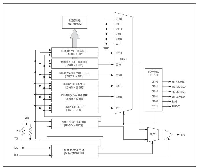
Figure 10. JTAG Block Diagram
