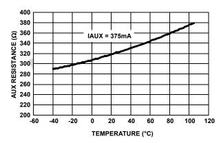
FIGURE 26. AUX  $r_{\text{DS(ON)}}$  vs TEMPERATURE
