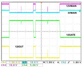
FIGURE 20. RETRY MODE OPERATION
