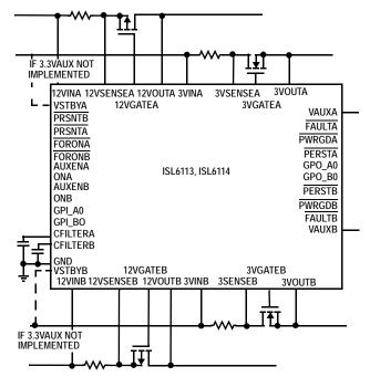
FIGURE 1. TYPICAL ISL6113, ISL6114 BLOCK DIAGRAM APPLICATION IMPLEMENTATION
