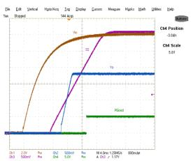
Fig. 18. Start up at 3A Load,  $Ch_1:V_{in}$ ,  $Ch_2:V_{o}$ ,  $Ch_3:V_{ss}$ ,  $Ch_4:V_{PGood}$
