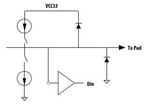
Figure 13. Low Speed IO Equivalent Circuit, ADR<2:0>
