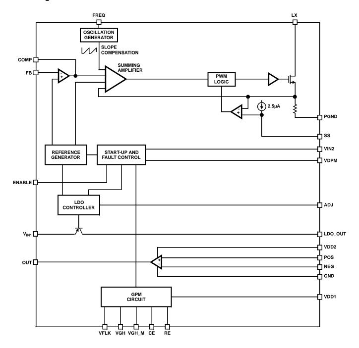
FIGURE 13. ISL97644 BLOCK DIAGRAM
