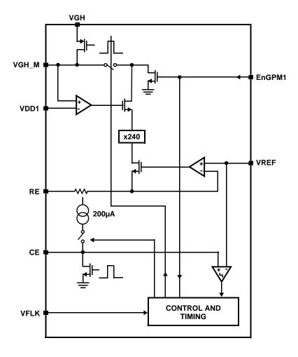
FIGURE 16. GATE PULSE MODULATOR CIRCUIT BLOCK DIAGRAM
