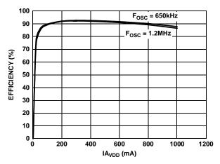
FIGURE 1. A<sub>VDD</sub> EFFICIENCY vs IA<sub>VDD</sub>
