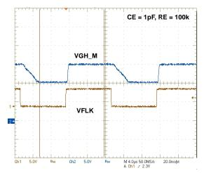
FIGURE 7. GPM CIRCUIT WAVEFORM
