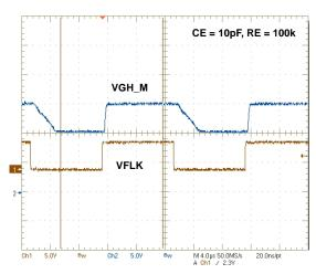
FIGURE 9. GPM CIRCUIT WAVEFORM
