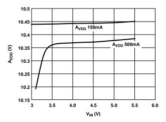
FIGURE 3. LINE REGULATION  $\mathrm{A_{VDD}}\ vs\ \mathrm{V_{IN}}$
