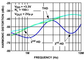
FIGURE 15. HARMONIC DISTORTION vs FREQUENCY
