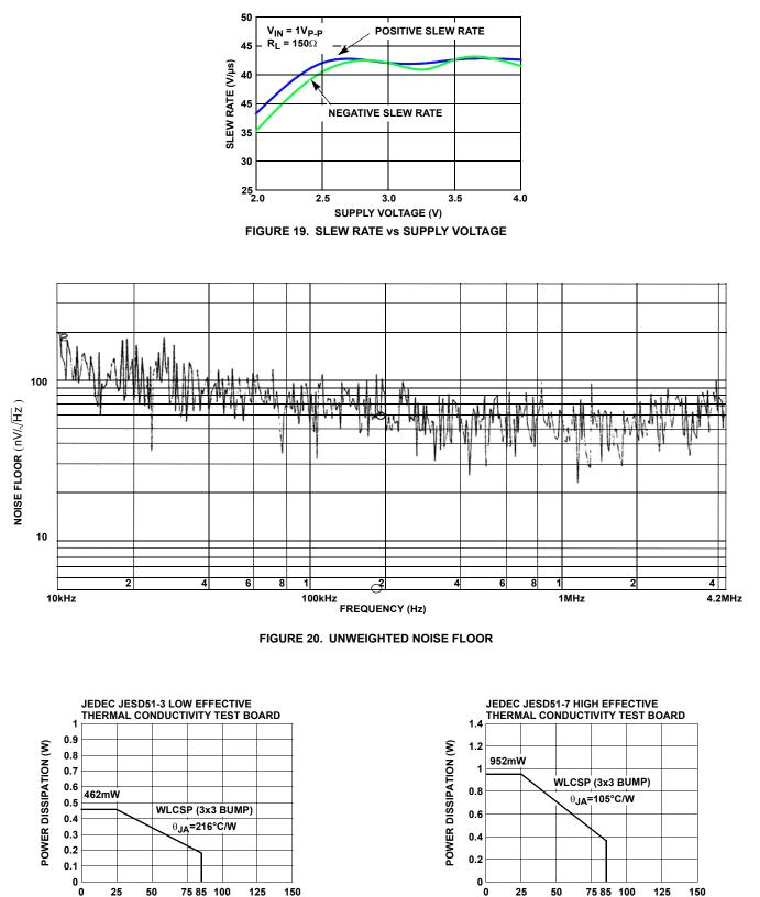
AMBIENT TEMPERATURE (°C) FIGURE 21. PACKAGE POWER DISSIPATION vs AMBIENT
