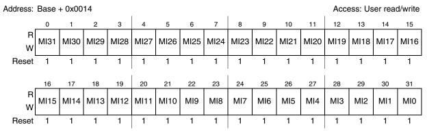
Figure 22-8. Rx Buffer 14 Mask register (RX14MASK)
