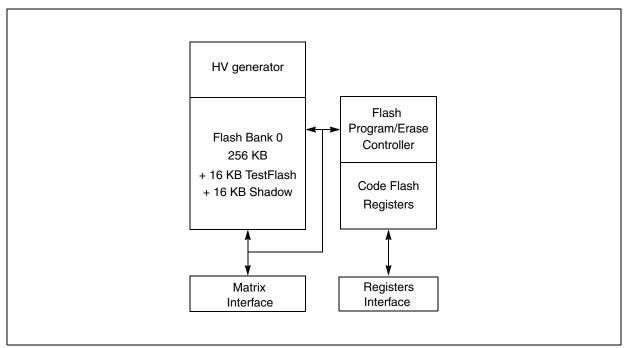
Figure 17-9. Code Flash module structure
