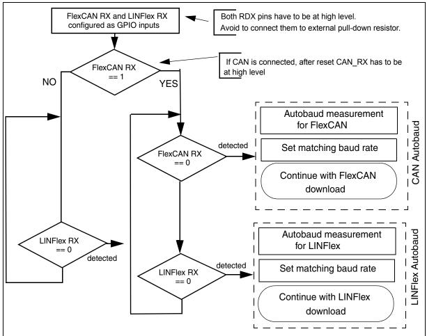
Figure 33-9. BAM Autoscan code flow
