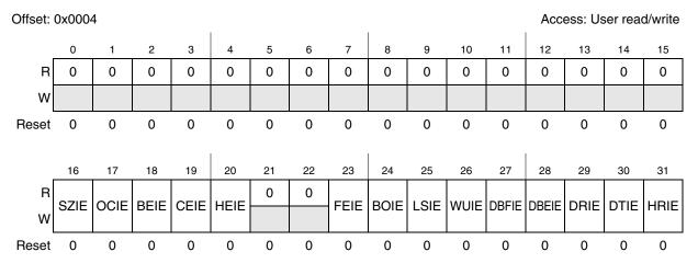
Figure 21-7. LIN interrupt enable register (LINIER)
