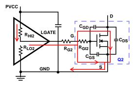
FIGURE 4. TYPICAL LOWER-GATE DRIVE TURN-ON PATH
