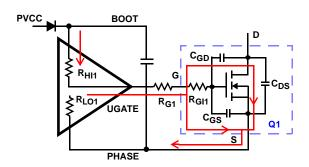
FIGURE 3. TYPICAL UPPER-GATE DRIVE TURN-ON PATH
